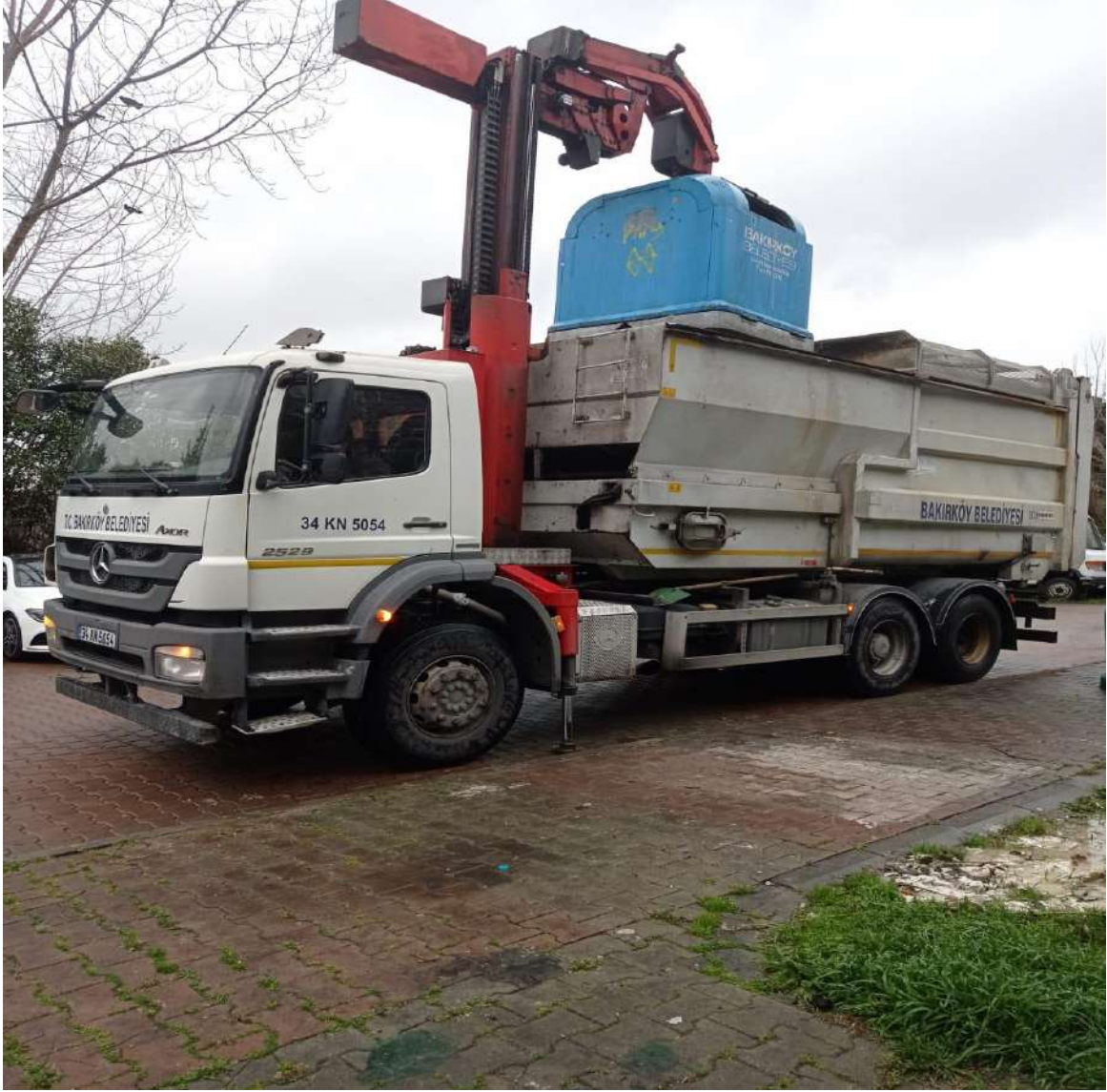
Şekil 1- Elektronik Vinç Sistemli ve Hidrolik Sıkıştırırmalı Çöp Kamyonu İle Evsel Atık Toplanması Faaliyeti
