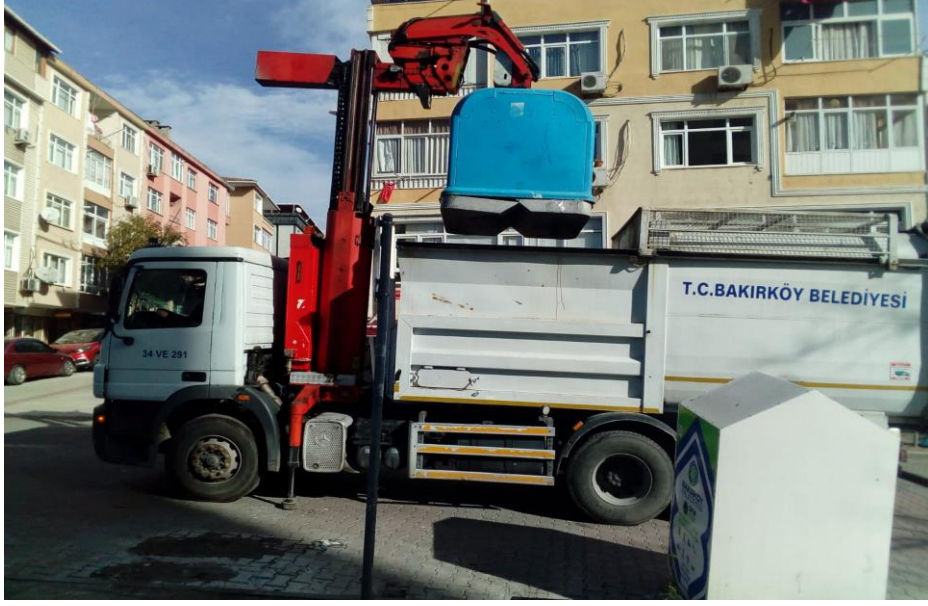
Şekil 1 Elektronik Vinç Sistemli ve Hidrolik Sıkıştırırmalı Çöp Kamyonu ile Evsel Atık Toplanması Faaliyeti
